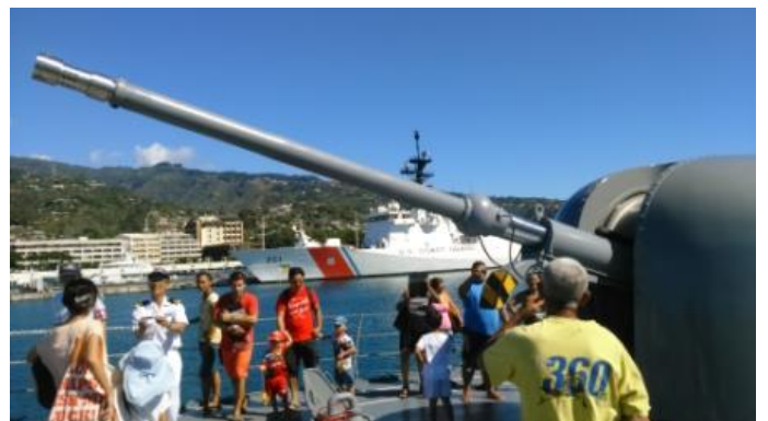
船首部に鎮座する 62 口径 76mm 単装速射砲
